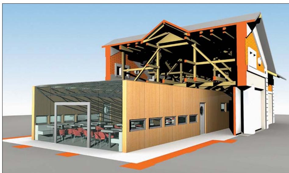
Takhle by se měla přeměnit bývalá stodola v sousedství Langerovy vily (viz i foto dole).
