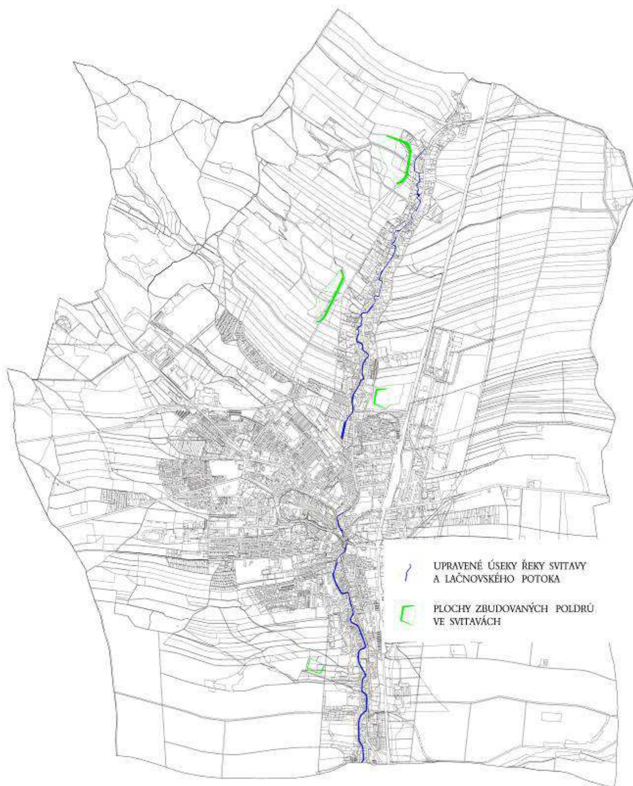
Obr. 2.1 Upravené úseky řeky Svitavy a Lačnovského potoka a plochy zbudovaných suchých poldrů ve Svitavách
